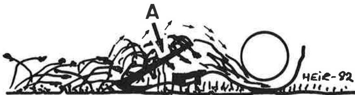
*Fig. 7. Ved høsting av noe seig frølo med en del frisk og grønn bunnvegetasjon, er det viktig for flyten av frøloa at den LØFTENDE delen — A — på legdeløfteren er smal. Dermed blir friksjonen mellom den løftende delen og frøloa liten, og faren for blokkeringer minimale.*
