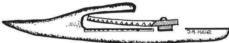
*Fig. 5. Dette skjæreapparatet vil fungere dårlig — spesielt ved skjæring av frølo. Kniv og fingerstål skal ligge godt an mot hverandre.*
